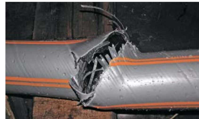
Рис. 9. Труба HexelOne® после испытания на давление разрыва в лаборатории компании E.ON в Эссене
