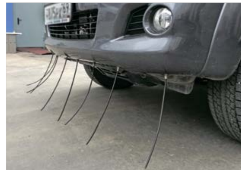
Фото 3. Пробоотборная система течейскаателя. Коридор отбора 14 м
