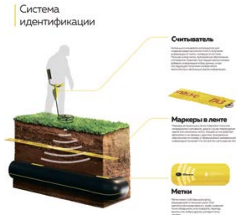
Рис. 1. Комплекс оборудования для радиочастотной идентификации трубопроводов
