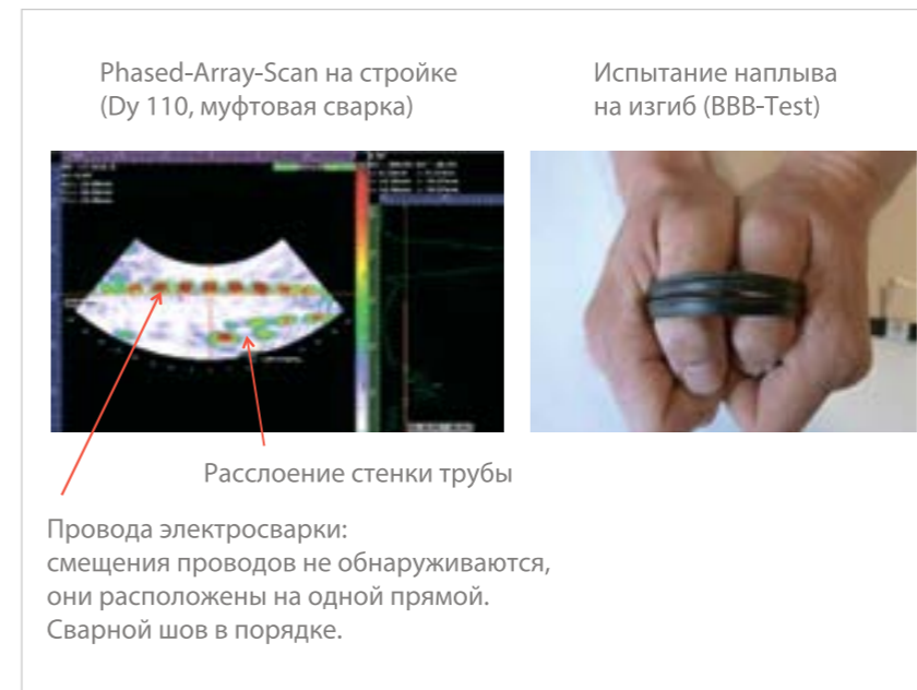
Рис. 16. Неразрушающие испытания многослойных пластиковых труб
