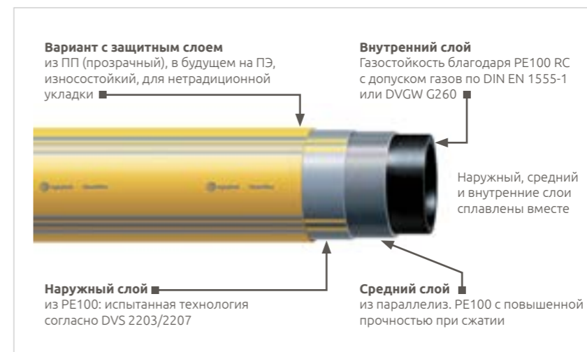
Рис. 4. Современная конструкция многослойной трубы высокого давления HexelOne®
