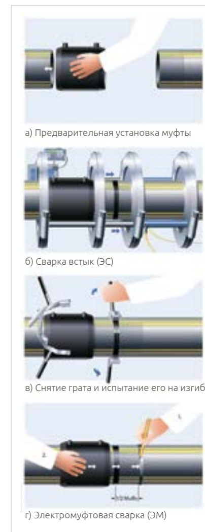
Рис. 5. Этапы соединения труб HexelOne®
